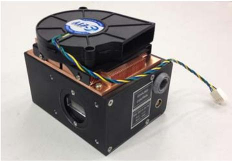
CH277型光子计数探测器是由侧窗光电倍增管、高压电源模块以及比较成形电路组成的光子计数器件，具有宽的光谱响应和动态范围。该探测器带有制冷器，通过配套的温度控制器进行控制，可降低光电倍增管的热噪声，从而在极弱光测量时仍具有良好的信噪比；可以应用于生物、医学、化学、环境等各个领域的弱光发光分析技术、精密测量分析中。本产品输出标准TTL信号，便于数据处理。出厂前，各参数点已经预设为最优值，用户只需按说明连接即可使用。
